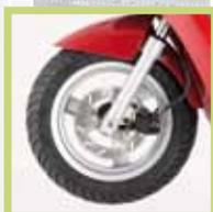
Roues 12" et frein avant à disque diam. 200mm
